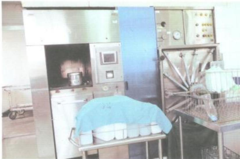
Foto 1: Frente derecho Autoclave "OPPICE" de 450 Litros - Frente Izquierdo Autoclave "AMSCO" de 1 m. cubico de volumen de Cámara de Esterilizado de Instrumental Quirúrgico.
